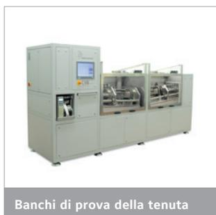
Banchi di prova della tenuta
