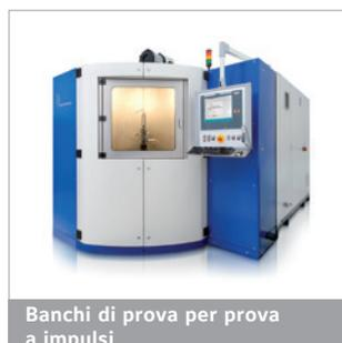
Banchi di prova per prova a impulsi
